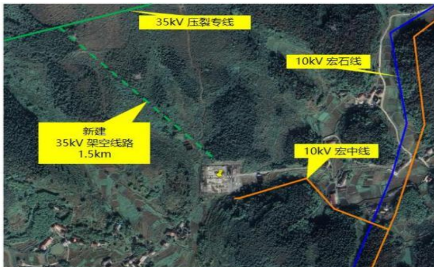
图 2.6-2 压裂期间电力线路走向示意图
